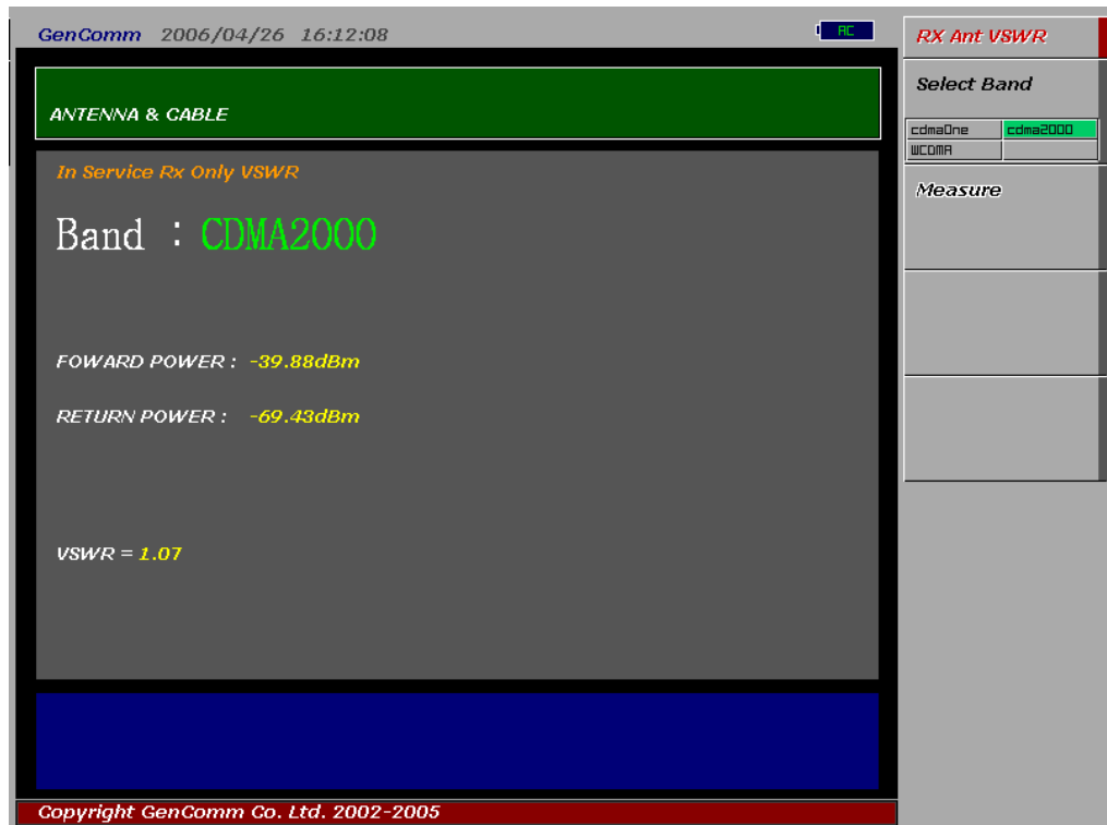
그림6.2.5 수신전용 안테나에 대한 In Service VSWR 측정결과
